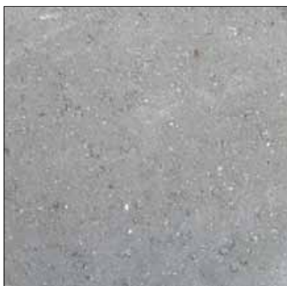
Billederne viser 2 ens sorte fliser, der er 8 år gamle. Den øverste har været tildækket, mens den nederste har ligget frit og derfor er bleget af solen mv.
